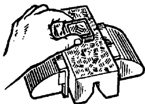
Рис. 13.13. Контроль качества шабрения плоских поверхностей с помощью рамки
