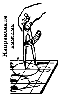
Рис. 3.21. Разметка окружностей
