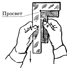
Рис. 8.26. Контроль отклонения от перпендикулярности с помощью угольника
