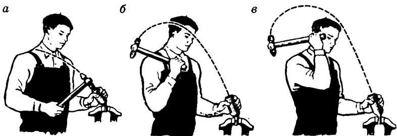
Рис. 4.10. Виды ударов при рубке:
