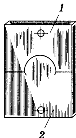
Рис. 11.7. Шаблоны: 1 — радиусный; 2 — контршаблон
